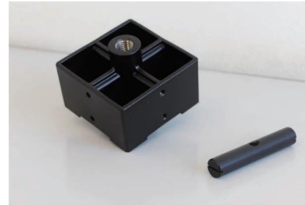
鹿沼 WooD INFILL のアジャスターベースは、SUSロストワックス材を、ドリフトピンは、鉄の丸棒を、各種マシニングセンターを利用して、精巧に創られております。
